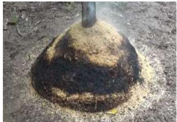
Gambar 2. Proses pembuatan arang sekam padi secara tradisional
