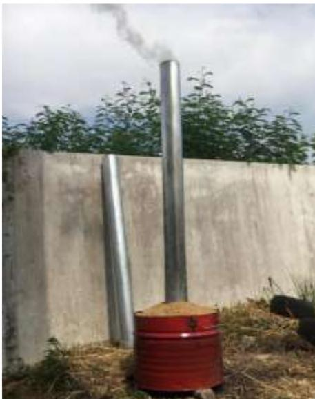
Gambar 12. Hasil uji coba alat produksi arang sekam
