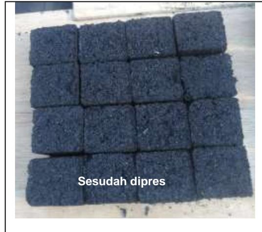
Gambar 13. Proses pencetakan briket arang sekam
