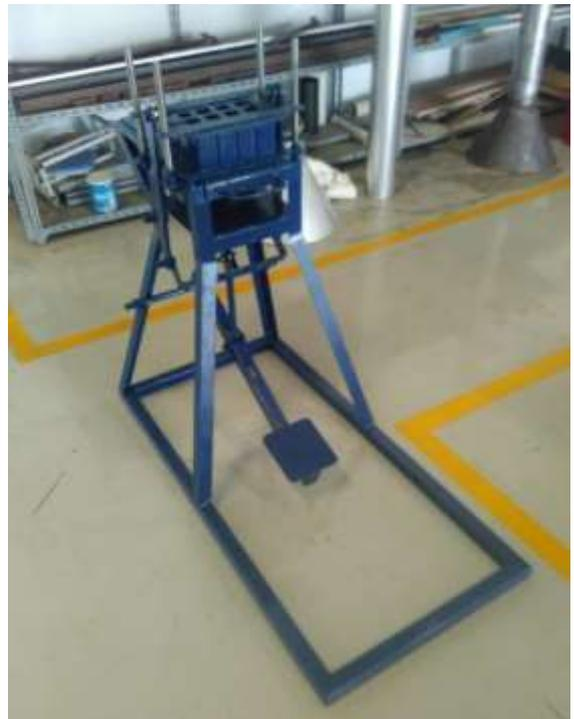
Gambar 11. Mesin pres briket arang sekam
