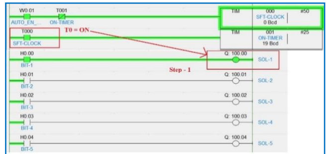
Gambar 18. Step Pertama pada Mode Otomatis, T0 = ON
