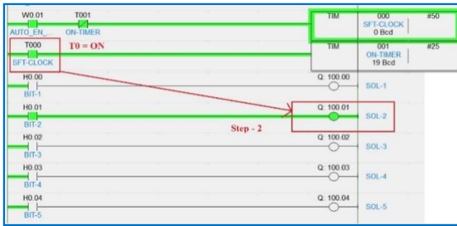
Gambar 20. Step Kedua pada Mode Otomatis, T0 = ON
