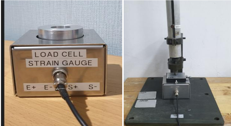
Gambar 1 : Pemasangan Load cell
