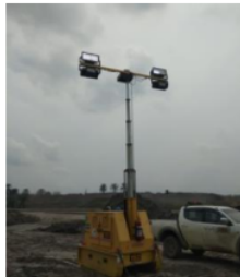
Gambar 1. Lampu LED NL500A terpasang pada towerlamp .
