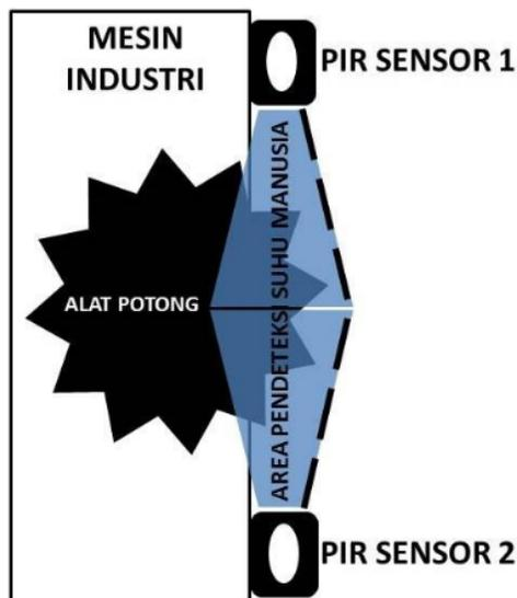
Gambar 5. Area deteksi Sensor PIR pada mesin industri.
