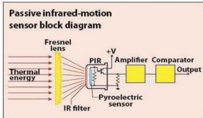
Gambar 2. Blok diagram dari lima komponen utama sensor PIR [17].
