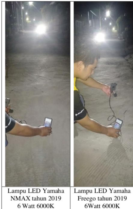
Gambar 13. Pengukuran intensitas cahaya (lux) lampu LED pabrik.
