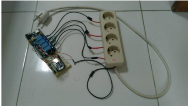
Gambar 6. Diagram Sirkuit Koneksi Modul Relai dengan NodeMCU ESP8266
